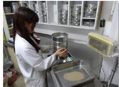
骨材試験 ▶ 骨材のふるい分け試験 ▶ 骨材の比重及び吸水率試験
