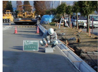
現場試験 ▶ 砂置換、RIによる土の密度試験 ▶ 平板載荷試験（地耐力試験）
