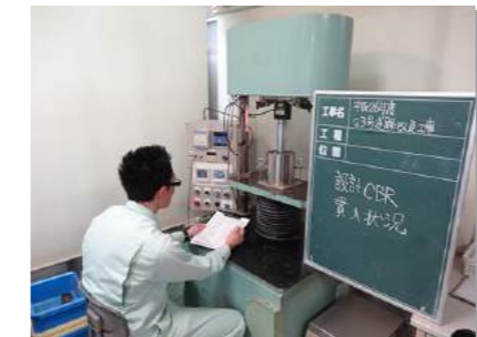
土質試験 ▶ 乱した土のCBR試験 ▶ セメント安定処理配合試験
