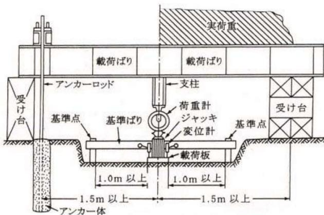
平板載荷試験は原地盤に載荷板(鋼鉄製、直径30cmの円盤)を設置して油圧ジャッキで地盤に荷重をかけて荷重の大きさと沈下量との関係から、地盤の支持力の特性を調査し、地盤が安全に支持するかを判定する試験方法です。試験に際し、反力荷重が必要となります。反力荷重としては現場の状況に応じてバックホウやH鋼、鉄板などを用います。
