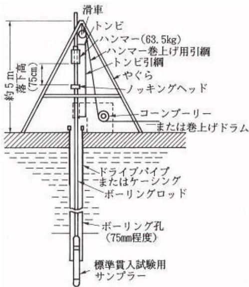
ボーリング調査は正式にはボーリング・標準貫入試験といいますが、あらかじめ所定の深度まで掘進したボーリング孔を利用して1mごとに地盤の硬さを測定する標準貫入試験を行う調査です。
